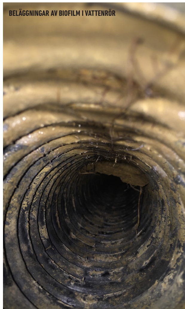
Vanligt förekommande beläggningar av biofilm i ett plaströr. Biofilmen fungerar som ett skydd för bakteriesamlingarna och försvårar eliminering av bakterierna.
